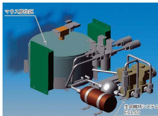
このシステムでは最長で約 34 時間、カプセル内部の環境を維持することが可能ですが、より長時間、微小重力下での実験を行うために考えられているのが、副衛星サイズ回収カプセルです。このシステムは、高度な生命維持装置を搭載しマウス 5 匹を使って 2 週間の宇宙実験を実現するものです。質量は約 40 kg、サイズは直径 1.2 メートル、高さ 40 センチの円柱状です。動物を長期間閉鎖系
